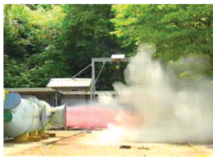
Explosion de 2 kilos d'amidon de maïs dans une cuve de 10 m 3 avec évent.
