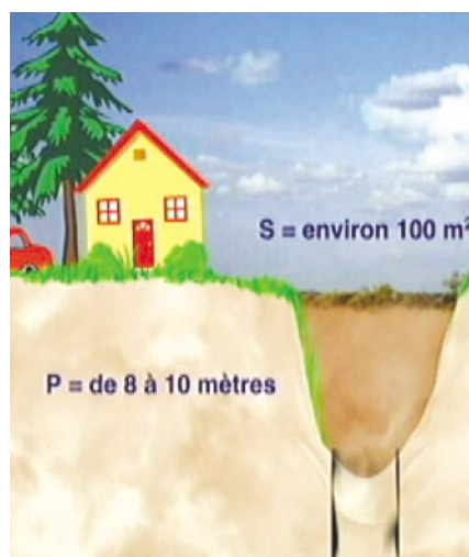
Schéma de principe d'un fontis.
