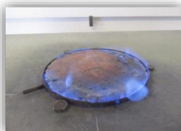
Les TMI en nuage et en couche permettent de définir une température limite de surface pour un matériel installé ou mis en œuvre en atmosphère explosible.
