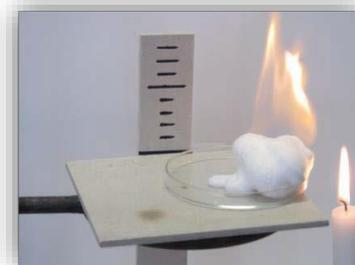
On considère comme inflammation, l'apparition d'une flamme stable d'au moins 4 cm de haut, maintenue pendant au moins 2 secondes. L'essai consiste à mesurer la hauteur et la durée de la flamme, dans différentes conditions.
