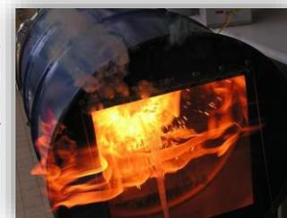
Si une inflammation se produit, le temps écoulé avant l'inflammation et la quantité de produit pulvérisée sont notés. Ceci permet de calculer la durée équivalente et la densité de déflagration.
