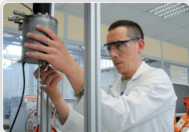
Détermination des isothermes d'adsorption au laboratoire
