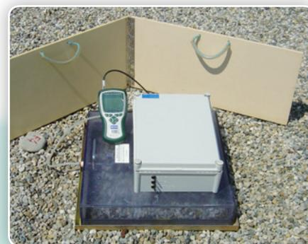
Mesure de flux de gaz en surface (Brevet INERIS)
