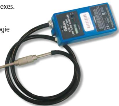
Système MPS avec pompe Gilian, tubulures et préfiltre.
