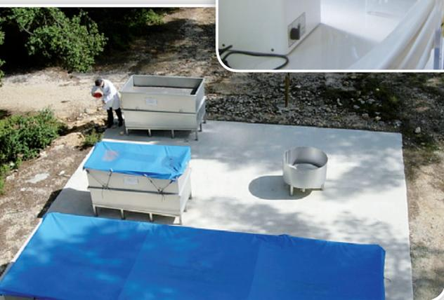
Essai pilote sur des sous-produits minéraux sur la plateforme lysimétrique d'Ardevie
