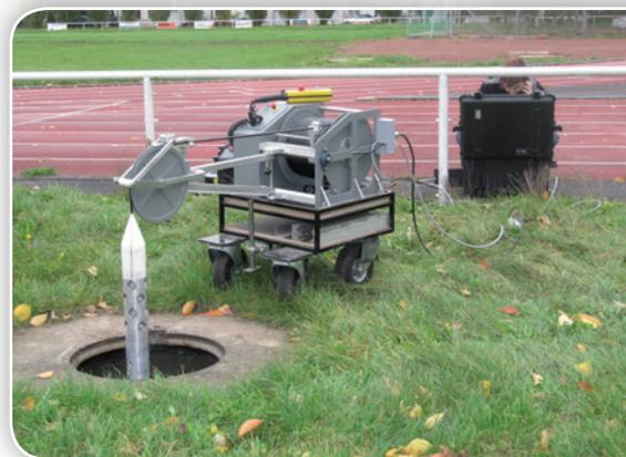
Inspection d'un puits par caméra pour recherche de galeries / Valenciennes
