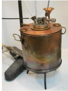
Appareil manuel Abel de mesure du point d'éclair pour le classement des liquides inflammables.
