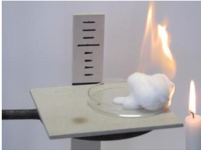
Essai d'inflammation d'une mousse d'aérosol pour le classement des aérosols inflammables.
