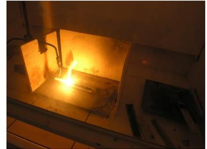
Essai de vitesse de propagation de la combustion sur un solide pour le classement des solides facilement inflammables.
