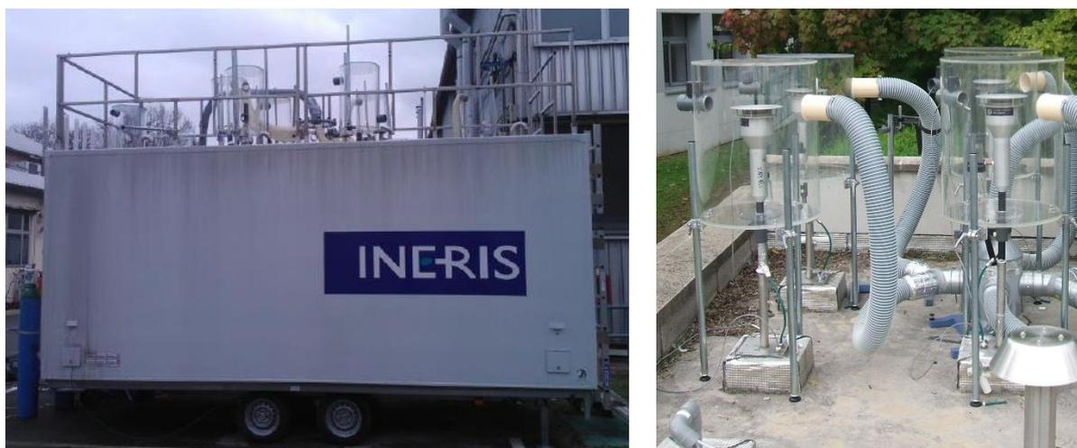
**Figure 4 : Remorque d'essais (gauche) et cloche de dopage (droite) utilisée lors des exercices de comparaisons inter-laboratoires des analyseurs automatiques de PM.**
