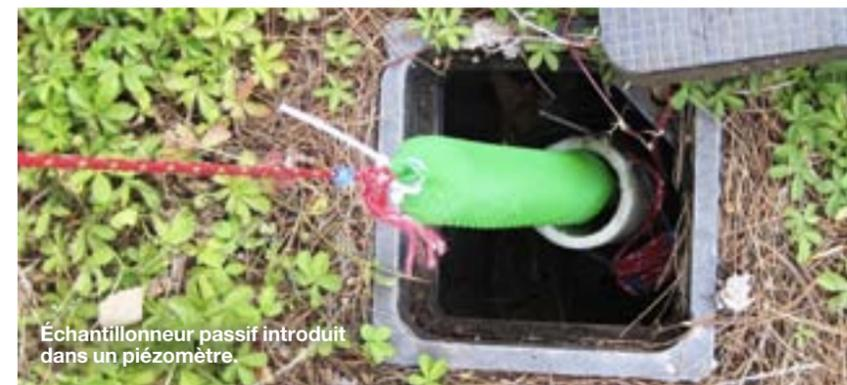
Échantillonneur passif introduit dans un piézomètre.
