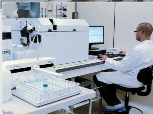
Analyse d'organométalliques par GC-ICP-MS
