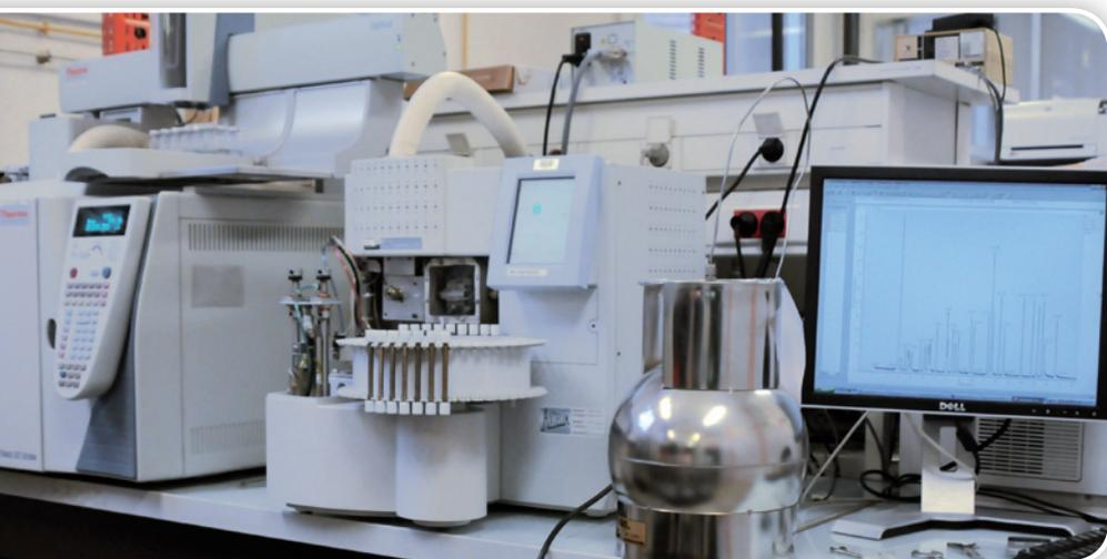
Analyse de COV dans un canister par GC-MS
